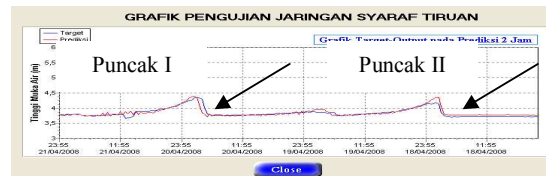
Gambar 8 Grafik pengujian antara target dan prediksi untuk data masukan 4 hari ke belakang
