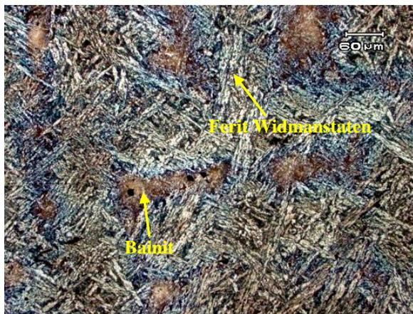
**Gambar 3.** Struktur Mikro AISI 4340 As Cast (AC)
