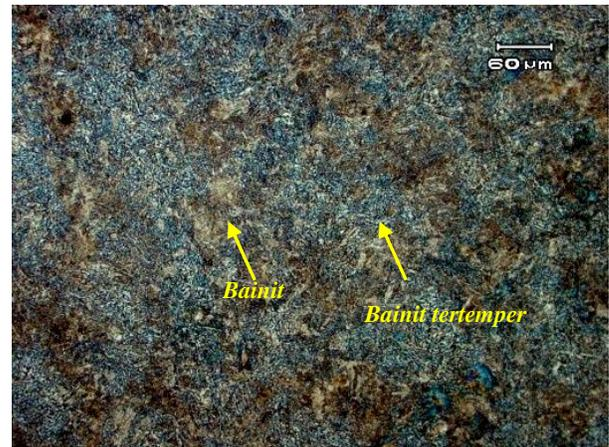
**Gambar 6.** Struktur Mikro AISI 4340 Hasil *Normalising*, *Tempering* 650 °C dan *Tempering* 650 °C (NTT650)
