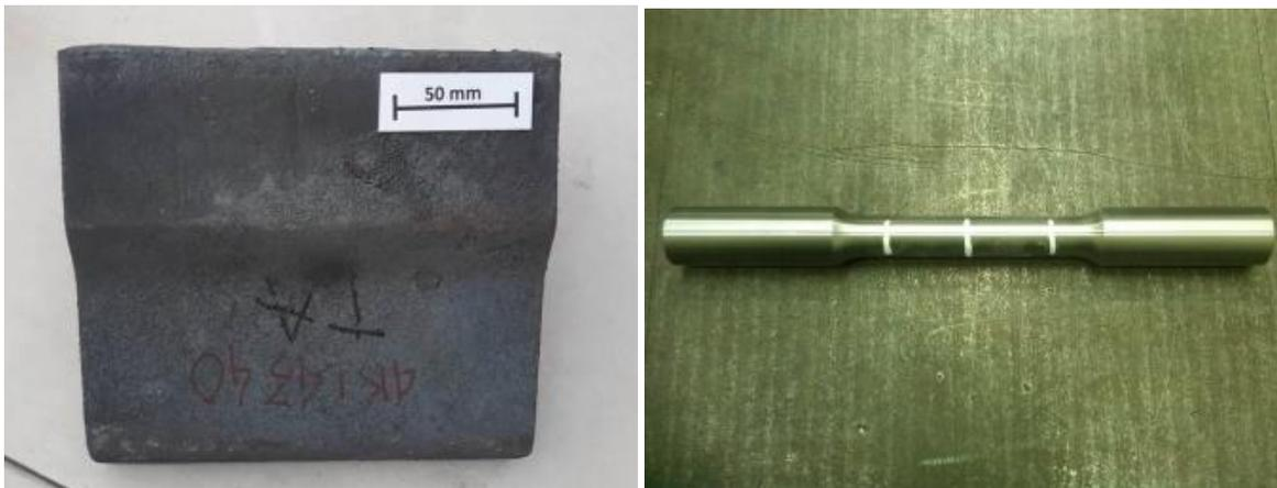
**Gambar 1.** Y Block dan Sampel Uji Tarik Baja AISI 4340
