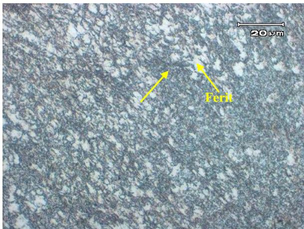
**Gambar 9.** Struktur Mikro AISI 4340 Hasil *Normalising*, *Tempering* 650 °C dan *Tempering* 705 °C
