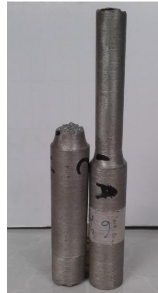
Gambar 7. Patahan tidak valid AlSi hasil pengecoran dengan variasi persentase pengikat lempung lokal Bangkalan 6% dan bentonit 0,5%.
