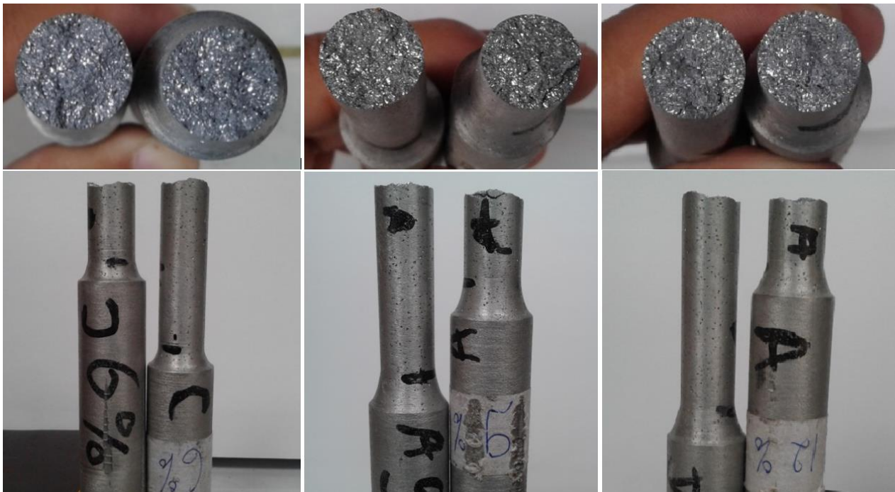
Gambar 5. (a) Foto makro patahan AlSi hasil pengecoran dengan variasi pengikat lempung lokal Bangkalan 6% dan bentonit 0,5%, (b) Foto makro patahan AlSi hasil pengecoran dengan variasi pengikat lempung lokal Bangkalan 9% dan bentonit 0,5%, (c) Foto makro patahan AlSi hasil pengecoran dengan variasi pengikat lempung lokal Bangkalan 12% dan bentonit 0,5% (Dokumentasi Peneliti)
