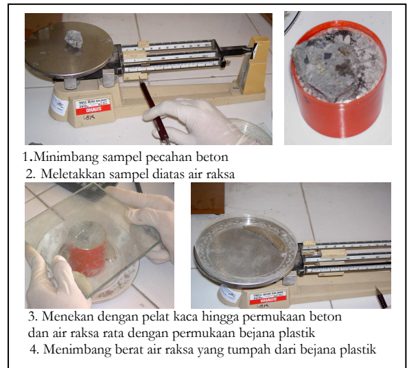
Gambar 6. Pengujian Berat Jenis Beton
