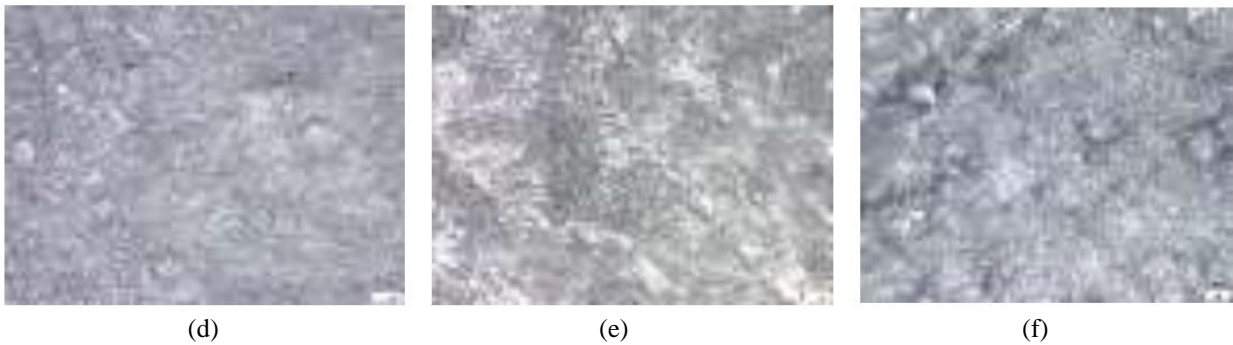
Gambar 10. Foto makro spesimen d, e, dan f setelah perendaman dalam media korosif air laut
