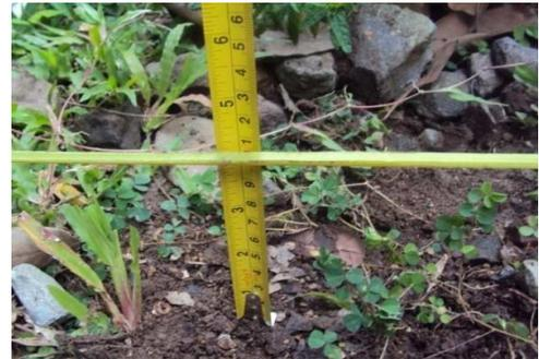
Gambar 11. Pengukuran Ketebalan agregat kelas B bagian tepi jalan (Simamora, 2010)
