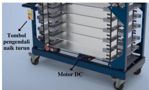
Gambar 6. Penggerak Alas Rak
