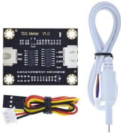
Gambar 3. Sensor TDS yang digunakan
