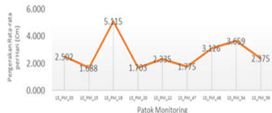
Gambar 1. Grafik pergerakan patok monitoring geoteknik Daerah Lowa wall pit Y PT Bina Sarana Sukses Bulan Oktober 2022.
