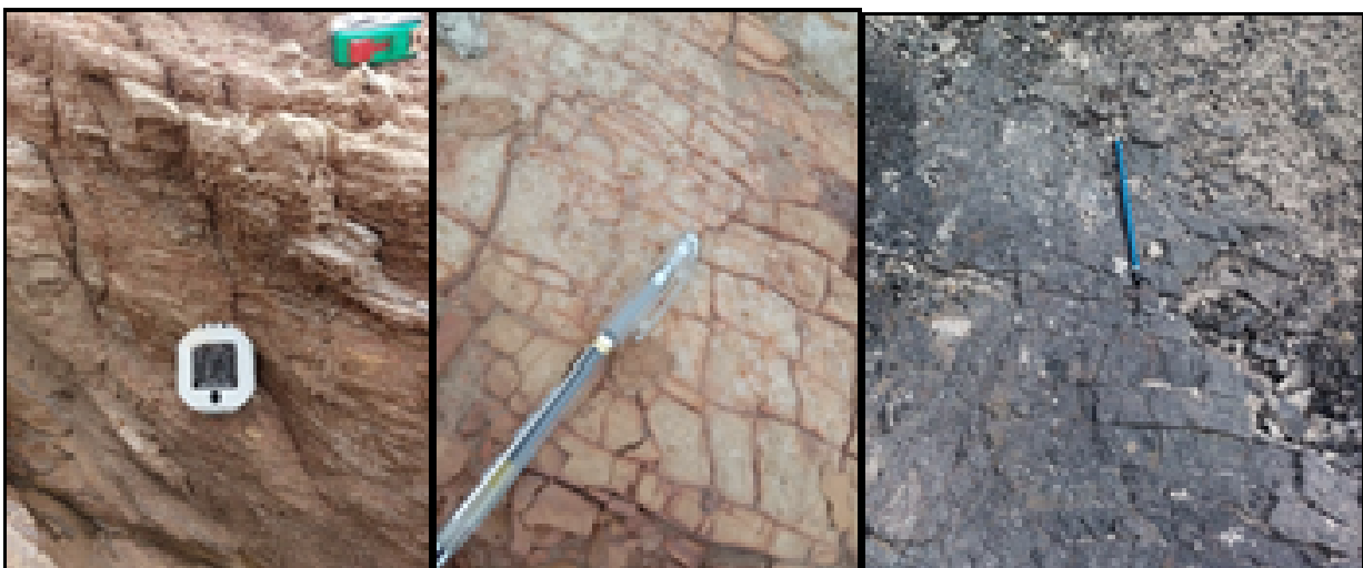
Gambar 2. Jarak antar kekar (a) litologi batupasir blok B2, (b) batupasir blok B4, (c) batubara blok B5
