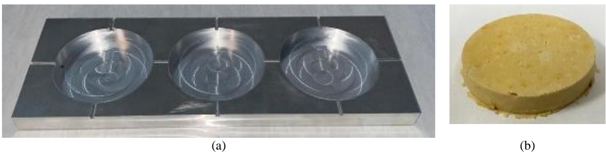
Gambar 1. (a) cetakan spesimen, (b) spesimen setelah vulkanisasi
