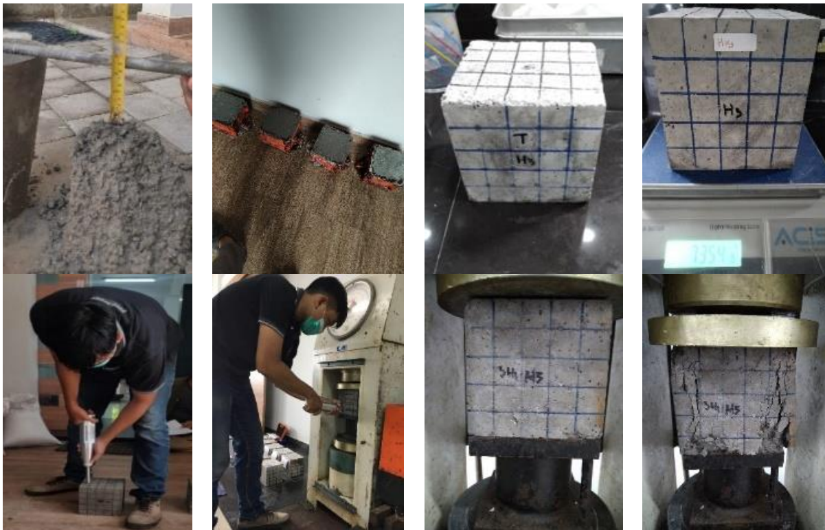
Gambar 3. Proses penyiapan data R_n dan f'_{ck}
