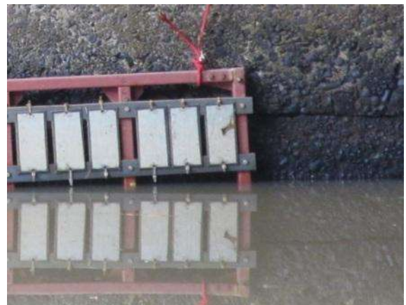
Gambar 2. Perakitan spesimen pada rak uji.
