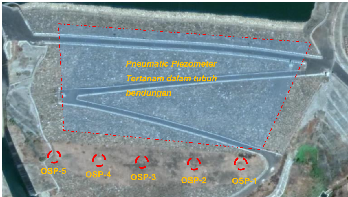
Gambar III-3 Lokasi Pemasangan Piezometer Open Standpipe Bendungan Bajulmati
