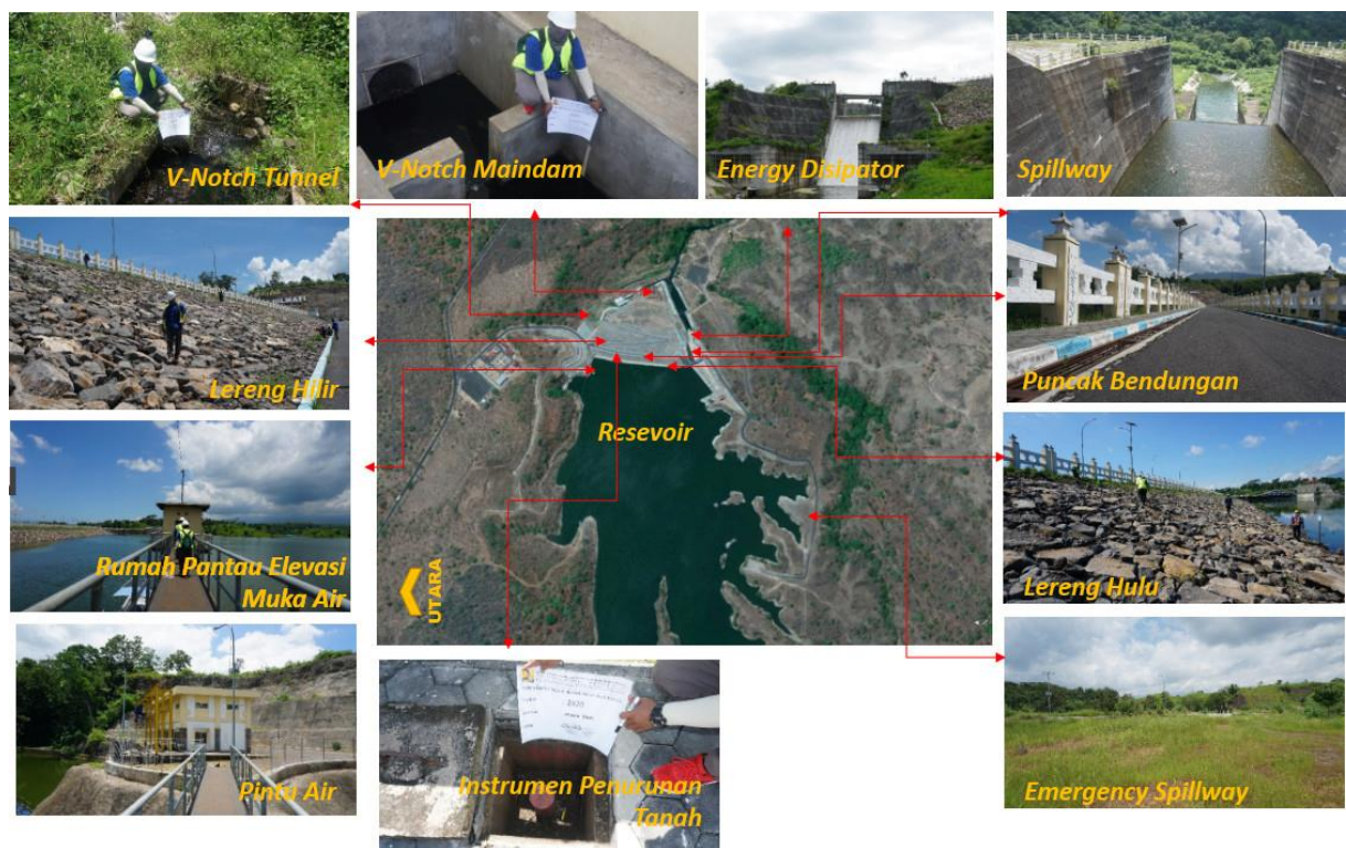
Gambar II.9 Tata letak Bendungan dan Bangunan Pelengkap Bajulmati
