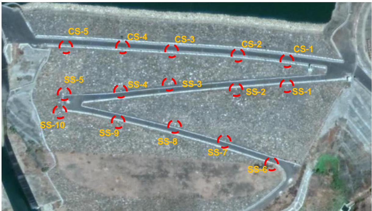
Gambar III-1 Lokasi Pemasangan Patok Geser Bendungan Bajulmati
