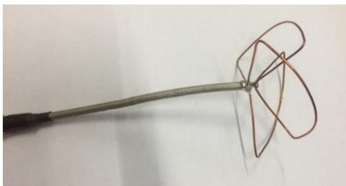
Gambar 8. Hasil Fabrikasi antenna *cloverleaf* desain optimal.
