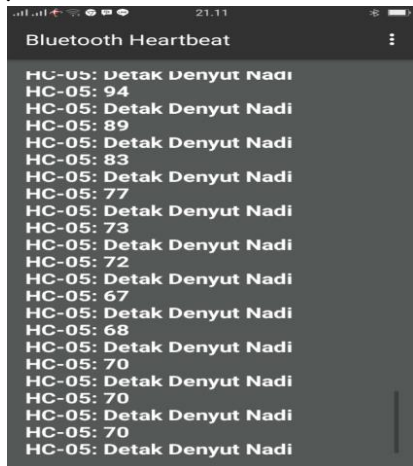
Gambar 7. Pengujian respon sensor heart rate terhadap denyut nadi
