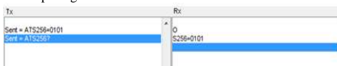
Gambar 19 Pengaturan register S256=0101
