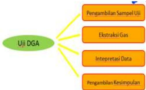
Gambar 2.3 Langkah Uji DGA
