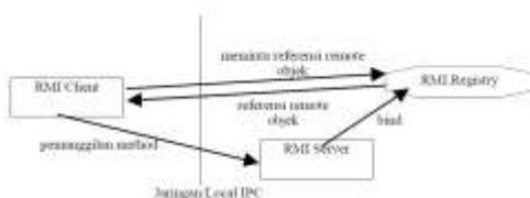
Gambar 3 Mekanisme kerja RMI
