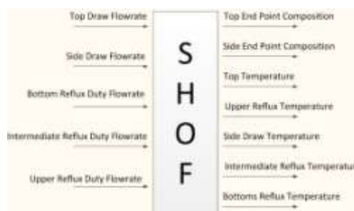
Gambar 3 Diagram Blok Sistem Masukan dan Keluaran Sinyal Kontrol Kolom SHOF
