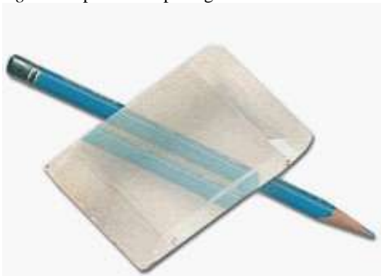
Gambar 3 Indeks bias ganda pada kristal Calcite
