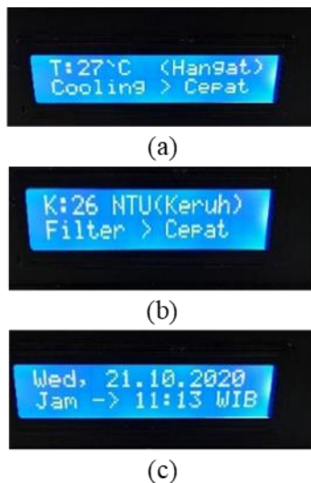
Gambar 17. Tampilan LCD (a) Menampilkan Data Suhu Air (b) Menampilkan Data Tingkat Kekeruhan Air (c) Menampilkan Data Waktu
