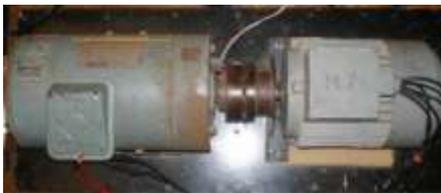
Gambar 3.2 Motor induksi 3 fasa dikopel dengan generator dc
