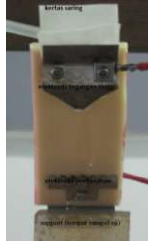
Gambar 3.21 Pemasangan sampel isolator
