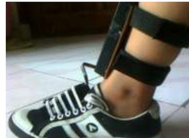
Gambar 3.2. Penempatan modul di kaki pengguna
