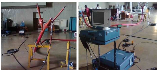
Gambar 9. Rangkaian pengujian tan \delta fungsi tegangan tanpa trafo luar
