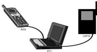
Gambar 3 Perangkat yang digunakan saat *drive test*.
