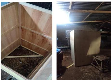
Gambar 20. Kotak Ruang Simulasi Menggunakan Dinding Triplek
