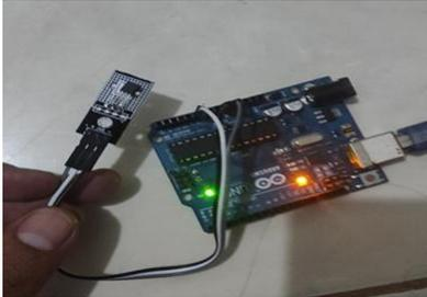
Gambar 12. Pengujian Sensor Suhu LM35
