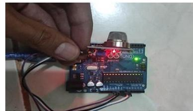
Gambar 17. Pengujian Sensor MQ2
