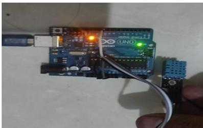
Gambar 14. Pengujian Sensor Suhu DHT11
