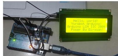
Gambar 16. Pengujian LCD I2C 20 x 4
