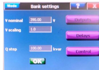
Gambar 5. View HMI RVT2-12 untuk sett scaling sensing current & Voltage
