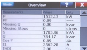
Gambar 9. Display Pengukuran Regulator RVT2-12 ABB Setelah Bekerja (6-step calling)
