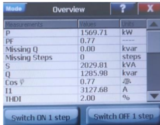
Gambar 8. Display Pengukuran Regulator RVT2-12 ABB Sebelum Bekerja (no-step calling)
