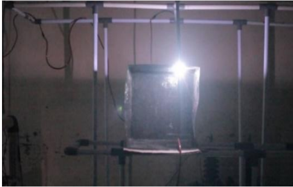
Gambar 6. Tegangan Tembus pada kotak uji CF-PANI 5%/CNT
