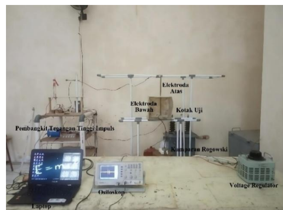
Gambar 2. Set Rangkaian Pengukuran di Laboratorium Teknik Tegangan Tinggi Jurusan Teknik Elektro Universitas Lampung
