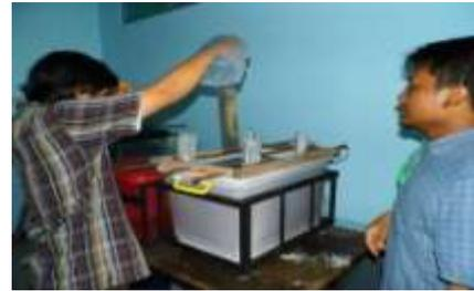
Gambar 9. Benda kerja dimasukkan ke dalam larutan pelapisan
