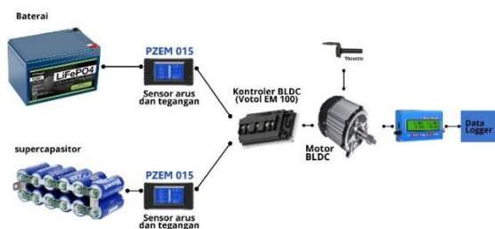
Gambar 4. Alur rangkaian pembacaan data simulator.
