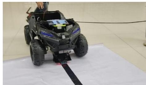
Gambar 11. Uji coba Inframerah pada AGV
