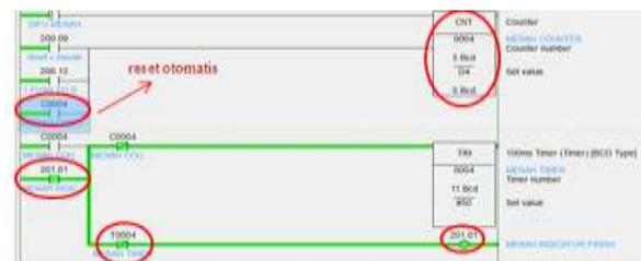
Gambar 4.5 perubahan nilai pada fungsi counter setiap warna di HMI
