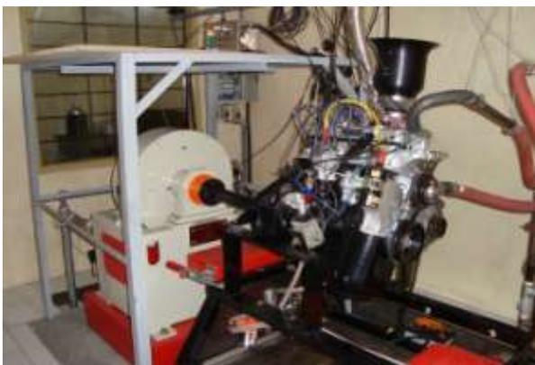
Gambar 5 : Dynamometer Engine Test Bed (ETB)
