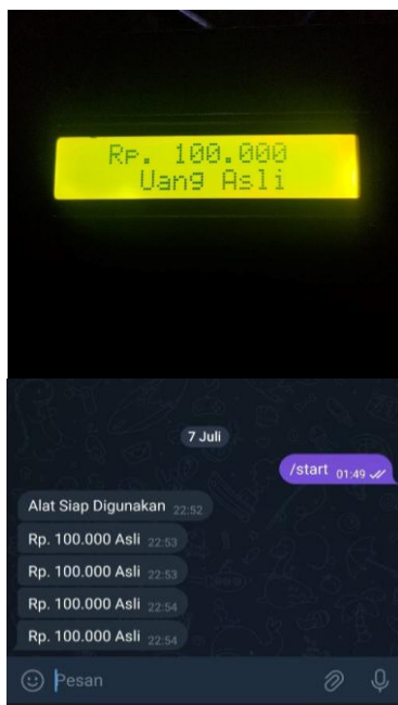
Gambar 9. Tampilan Alat dan Notifikasi Telegram Saat Deteksi Uang Asli
