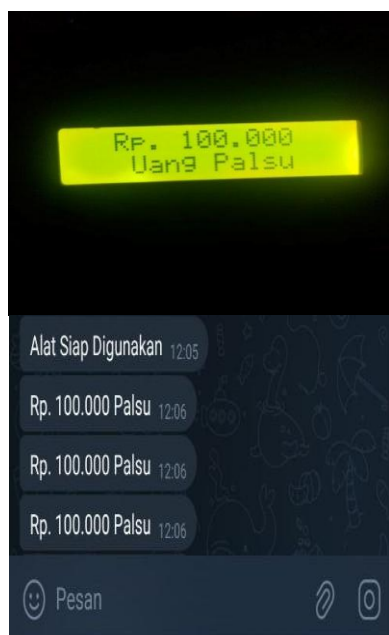
Gambar 10. Tampilan Alat dan Notifikasi Telegram Saat Deteksi Uang Palsu
