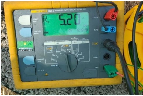
Gambar 5. Nilai pengukuran pentanahan yang baru
