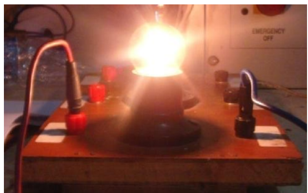
Gambar 7 Lampu pijar menyala saat mode Automatic dan kondisi PLN normal
