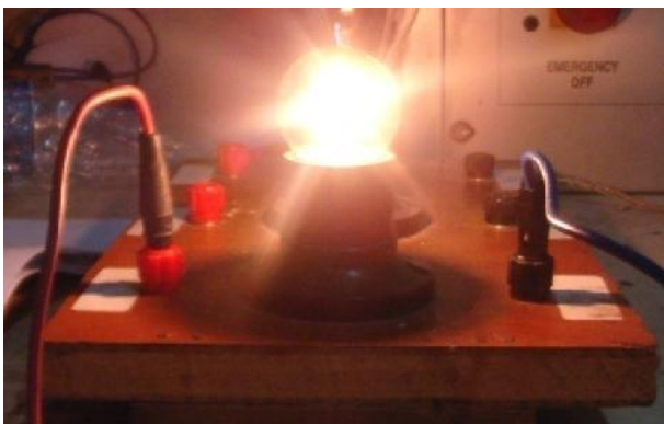
Gambar 4 Lampu pijar menyala saat mode manual Genset berhasil
