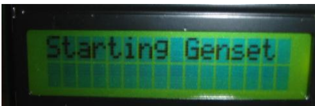
Gambar 9 Tampilan Pada LCD saat perintah starting Genset
