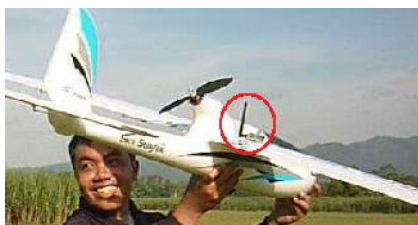
Gambar 16. Antena Video Transmitter Yang Terhalang Badan Pesawat
