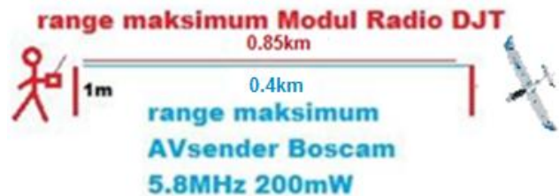
Gambar 13. Uji Coba Range Di Udara
