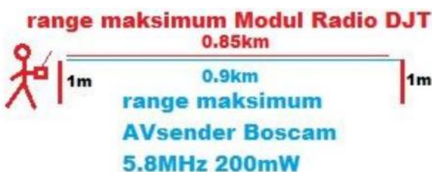
Gambar 12. Uji Coba Range di Darat
