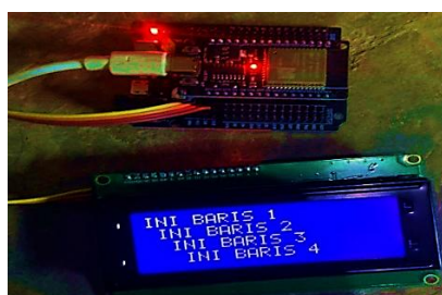
Gambar 13. Pengujian Fungsional LCD
