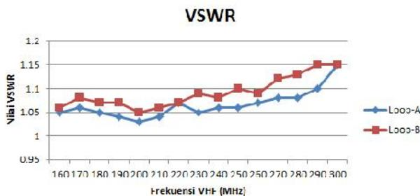
Gambar 7 Grafik hasil pengukuran VSWR antena *delta loop* pada pita VHF
