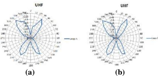
**Gambar 16 Hasil pengujian pola radiasi antenna delta loop pada pita UHF dengan (a) Antena Loop-A dan (b) Antena Loop-B**
