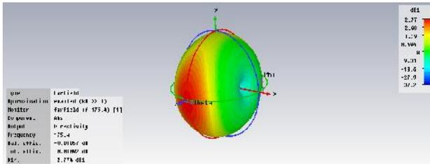
Gambar 9 Hasil simulasi gain antena delta loop pada pita VHF
