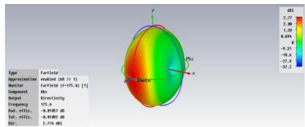
Gambar 13 Hasil simulasi pola radiasi 3D antena delta loop pada pita frekuensi VHF
