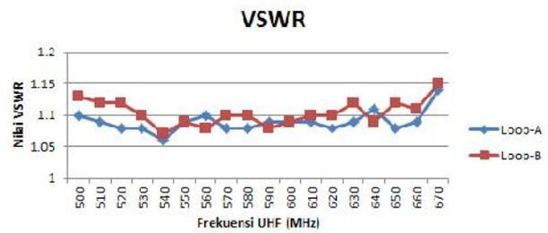
Gambar 8 Grafik hasil pengukuran VSWR antena *delta loop* pada pita UHF
