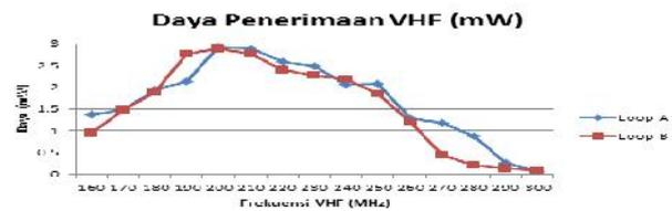
Gambar 5 Grafik pengujian daya terima antenna *delta loop* pada pita frekuensi VHF
