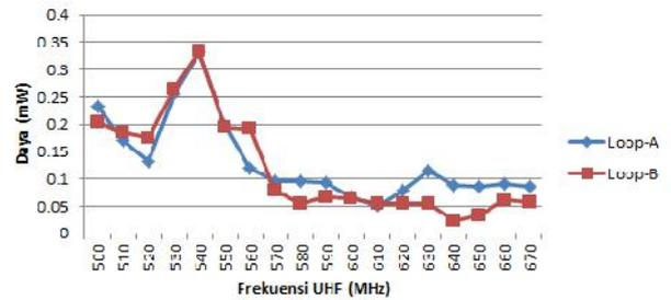
Gambar 12 Grafik pengujian daya penerimaan antena delta loop pada pita frekuensi UHF
