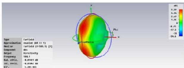
Gambar 14 Hasil simulasi pola radiasi 3D antena delta loop pada pita frekuensi UHF
