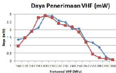
Gambar 11 Grafik pengujian daya penerimaan antena delta loop pada pita frekuensi VHF
