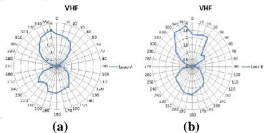
**Gambar 15 Hasil pengujian pola radiasi antenna delta loop pada pita VHF dengan (a) Antena Loop-A dan (b) Antena Loop-B**
