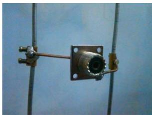
**Gambar 2.** Feedpoint yang terpasang pada antenna J-Pole-T
