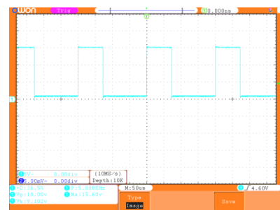
Gambar 9. Gelombang keluaran IC TL494 saklar 2, probe x1, 50 μs, 5 V/div
