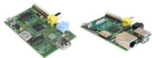
Gambar 1. Raspberry Pi Model A (atas) dan Raspberry Pi Model B (bawah)
