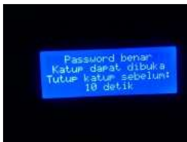
Gambar 6. Respon prototipe bila katup dibuka dengan password yang benar
