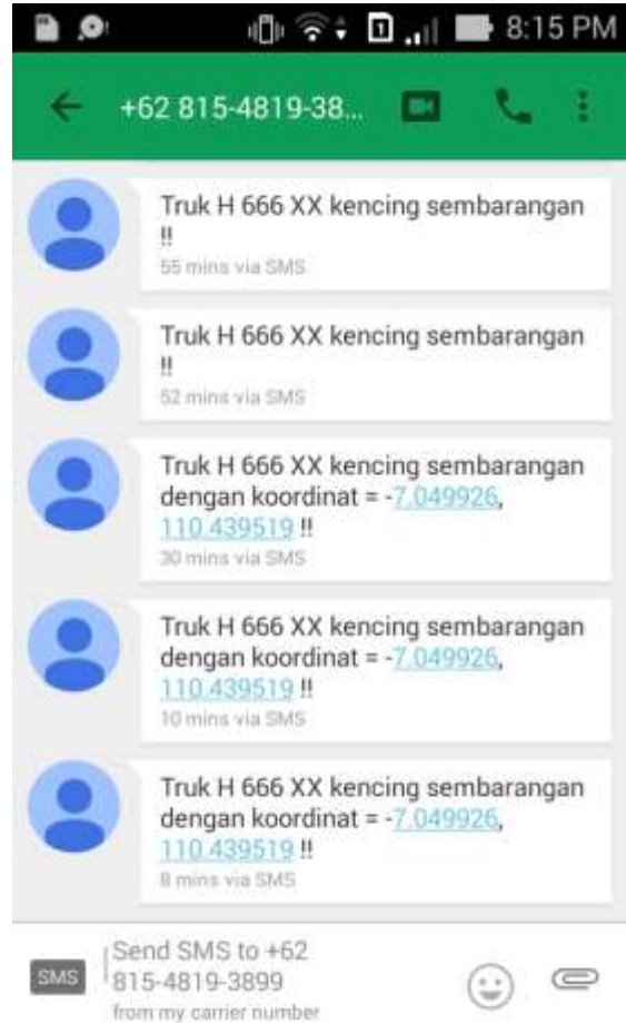
Gambar 7. SMS yang diterima bila katup bottom loader dibuka tanpa memasukkan password yang benar
