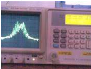
Gambar 24. Pengujian Daya yang dikeluarkan rangkaian FM.
