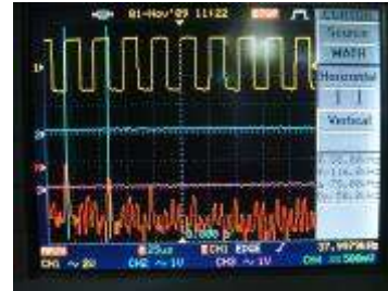
Gambar 19. Keluaran osilator kristal 38 KHz.
