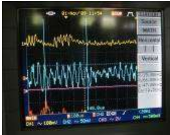
Gambar 28. keluaran tapis pelolos bawah 19 KHz.
