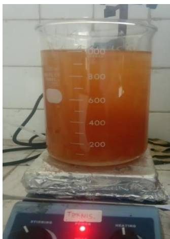
Gambar 3.8 Pencampuran Serat, HCl, Polianilin, dan Ammonium Persulfat
