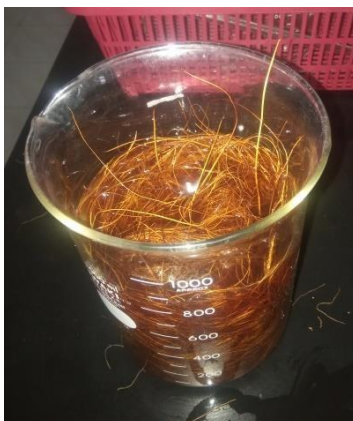
Gambar 3.4 Rendaman Serat Kelapa dengan 2% NaOH
