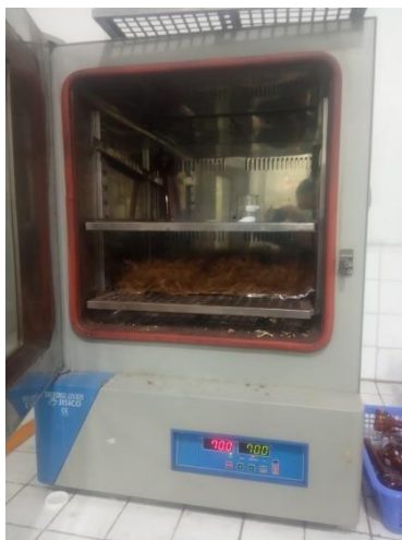
Gambar 3.6 Pengeringan Serat Kelapa Dengan Oven
