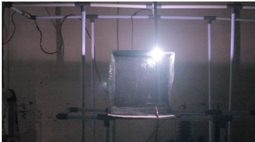
Gambar 4.4 Tegangan Tembus pada kotak komposit CF-PANI 5%/CNT
